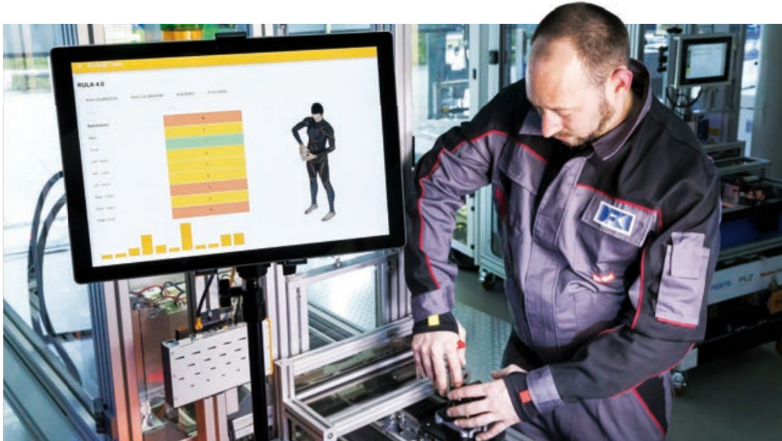
Überwachung für einen guten Zweck: Sensoren in der Arbeitskleidung erfassen Bewegungsabläufe und leiten die Daten an eine Auswertungs-Software weiter. Diese informiert den Mitarbeiter über eine falsche Körperhaltung oder ungünstige Bewegungen. So wollen Forscher der TU Kaiserslautern und des DFKI gesundheitlichen Schäden vorbeugen. Seite 50
